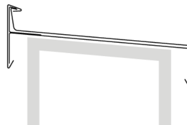
Szkic 11: Obróbka dwuelementowa z odgięciem
