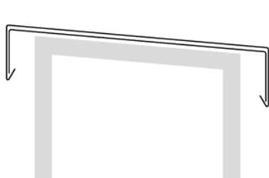
Szkic 9: Obróbka jednoelementowa
